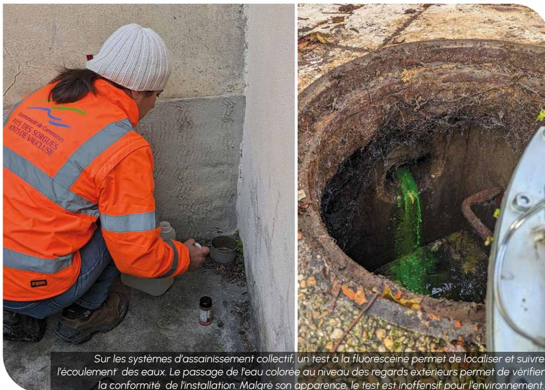
Sur les systèmes d'assainissement collectif, un test à la fluorescéine permet de localiser et suivre l'écoulement des eaux. Le passage de l'eau colorée au niveau des regards extérieurs permet de vérifier la conformité de l'installation. Malgré son apparence, le test est inoffensif pour l'environnement.
