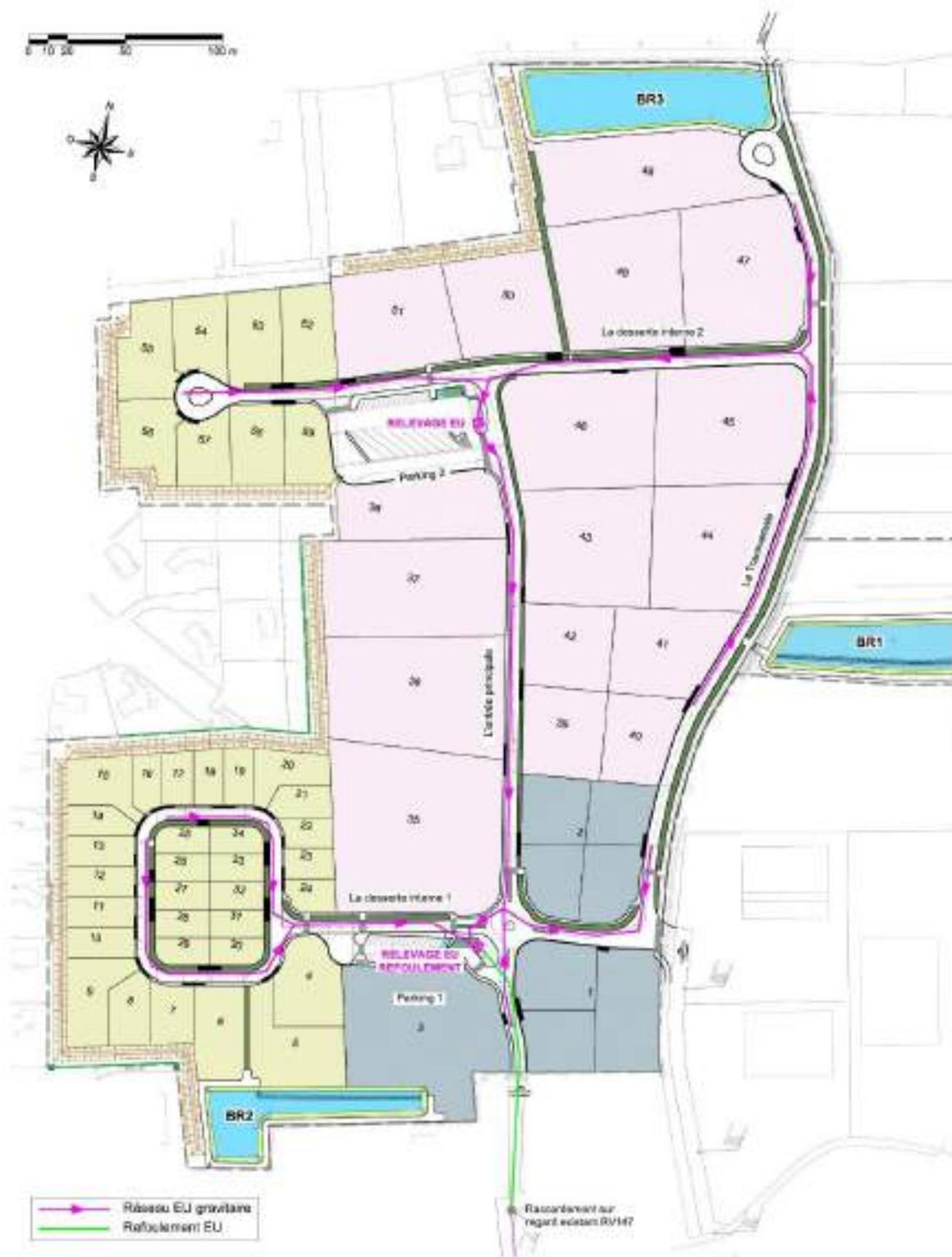
Figure 64 : Schéma de principe du réseau d'eaux usées
