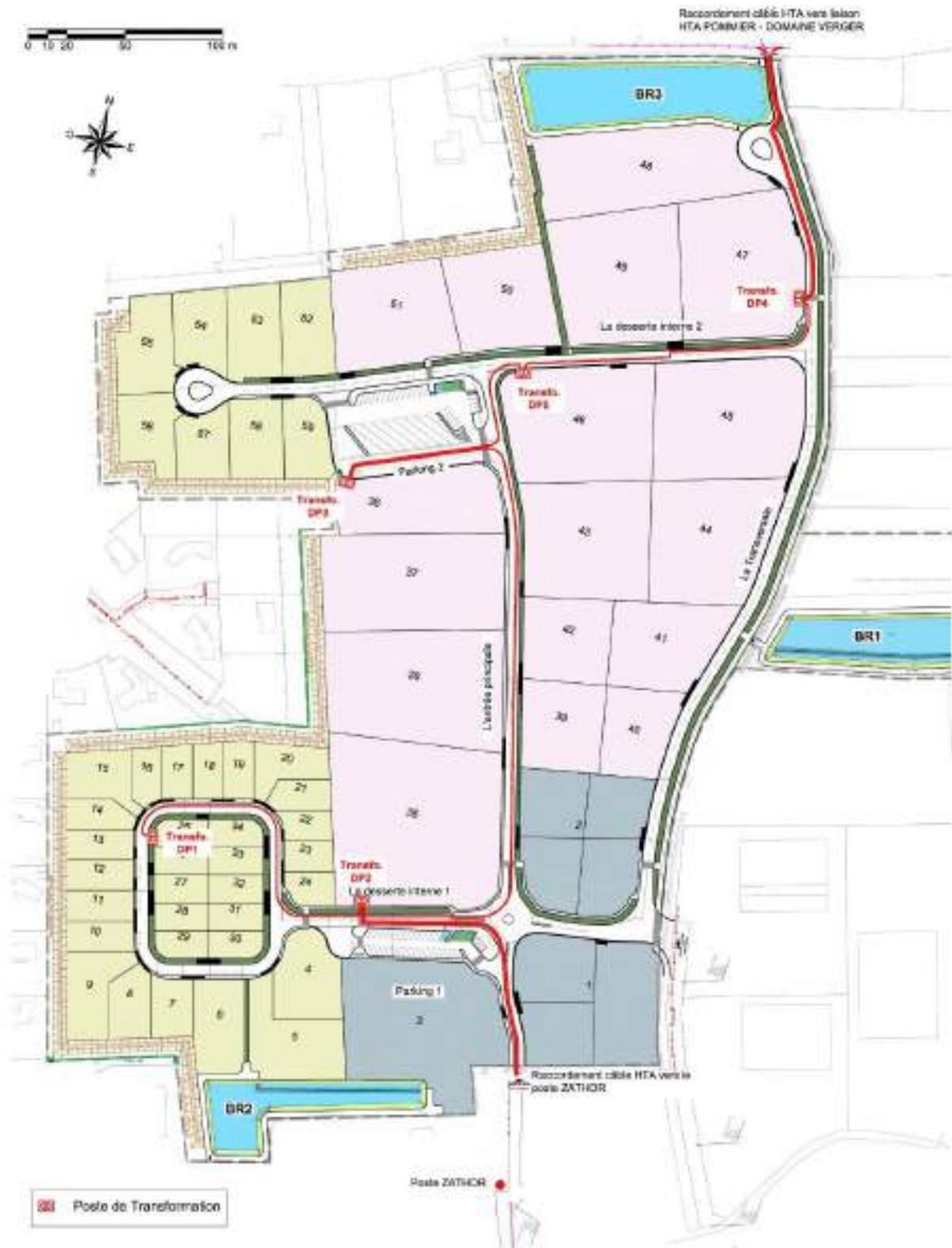
Figure 62 : Schéma de principe du réseau électrique
