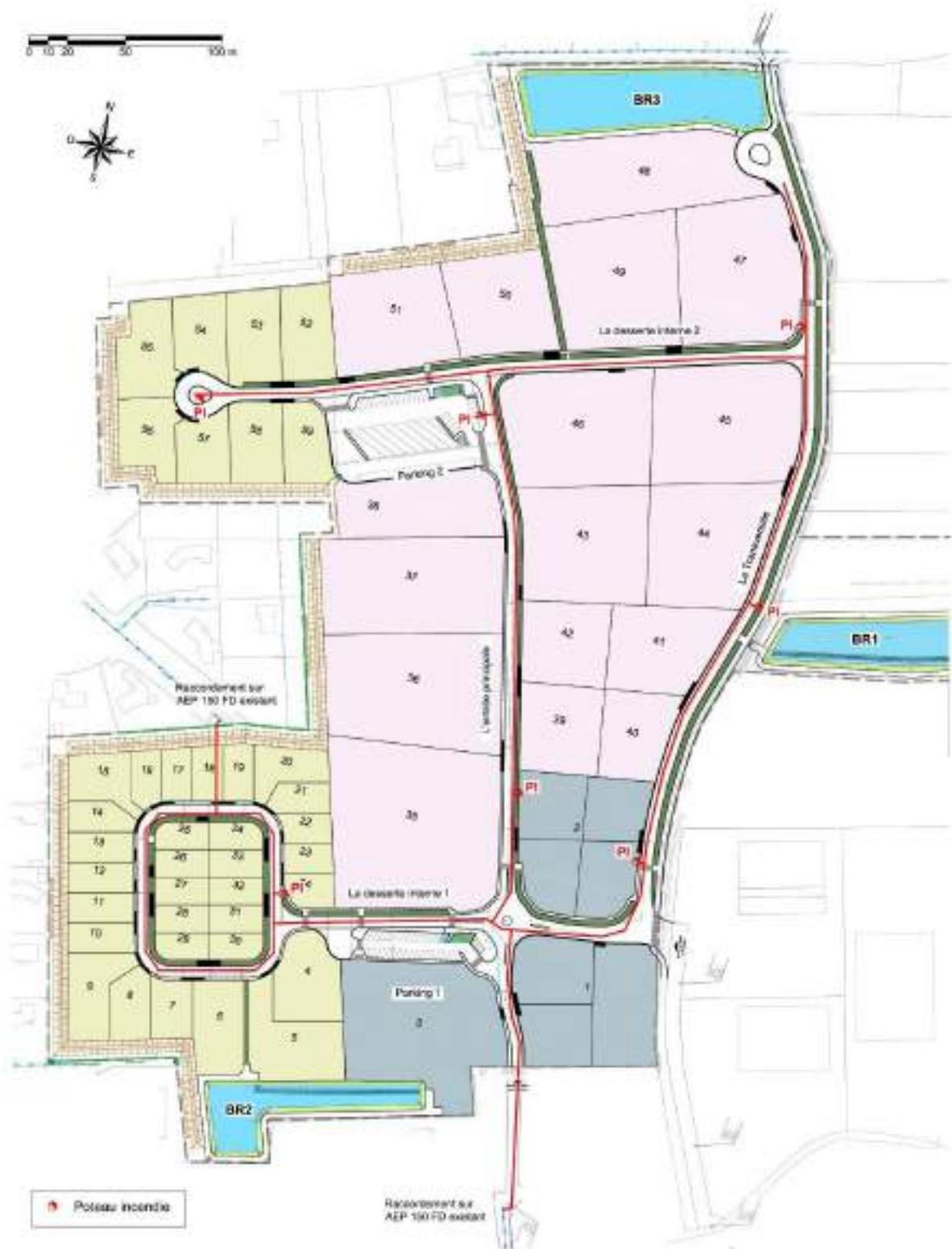
Figure 63 : Schéma de principe du réseau incendie
